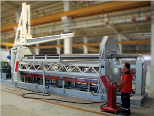
Pre-stressed plate bending machine for pipe production Boru üretimi için ön gerilmeli özel silindir makinesi
