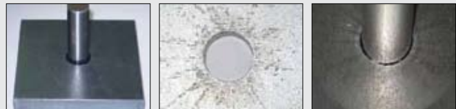
HPRXD® Plazma ile True Hole teknolojisi kullanarak kesilen 12 mm'lik sac. 12 mm hole with True Hole technology cut with HPRXD® Plasma.
