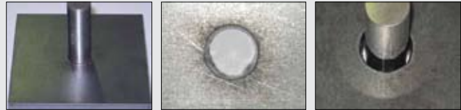
HPRXD® Plazma ile True Hole teknolojisi kullanmadan kesilen 12 mm'lik sac. 12 mm hole without True Hole technology cut with HPRXD® Plasma.
