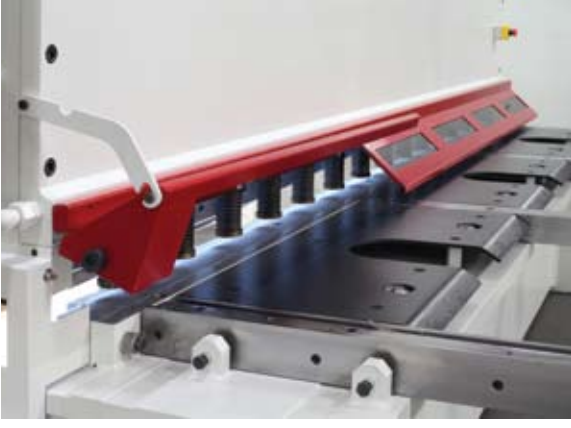
1000 mm açılabilir, emniyet siviçli ön muhafaza 1000 mm lift-up front finger guard with electrically interlocked safety switch
