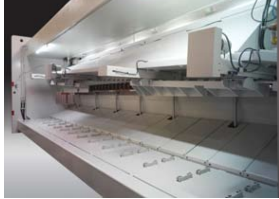
Burulma önleyici sistem Anti twisting system
